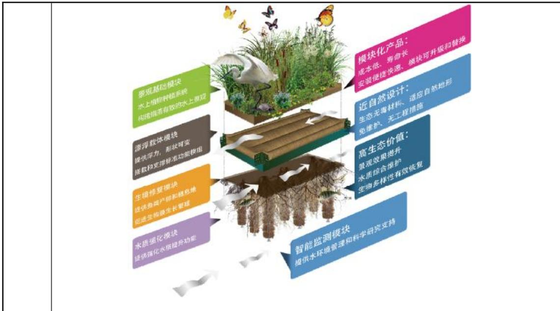
图 2-7 漂浮生境岛功能结构示意图
